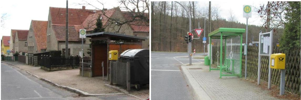
*Fotos: Beispiele für Fahrgastunterstände im Untersuchungsgebiet: links an der Haltestelle „Dippelsdorf, Großenhainer Straße“ keine Sichtbeziehung auf den ankommenden Bus/ allgemein schlecht einsehbar; rechts „Auer, Gasthof“ mit transparenten Seitenflächen*
